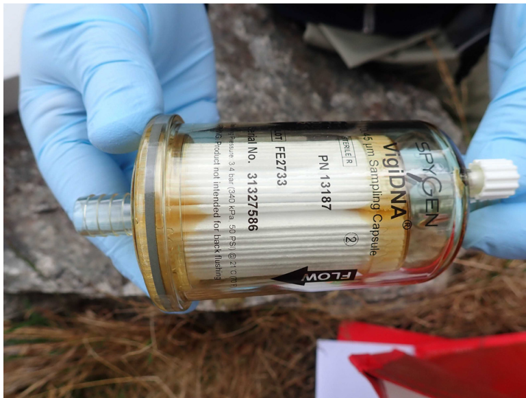
Filtre (45µm) sur lequel les fragments d'ADN se fixent.
