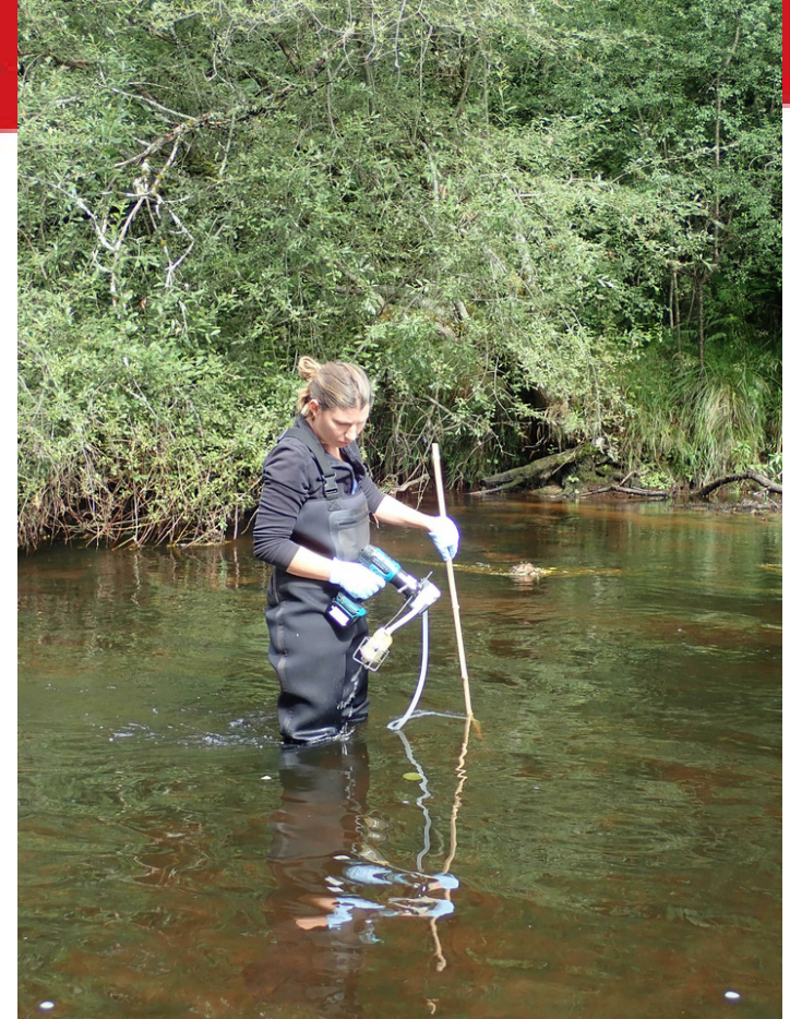
Prélèvement d'eau via une pompe et filtration.
